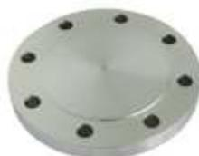
Usadas para interromper a passagem de fluidos em tubulações, válvulas e bombas. São usadas também para facilitar a inspeção da linha. São recomendadas para trabalhos em qualquer situação de pressão e temperatura desde que não sujeitos a golpes de aríete (choques de pressão).
