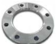
Estas flanges são apropriados para pestanas (stub-ends). Não são fixadas as tubulações por solda somente fixada ao outra flange por parafusos, o que é facilitado por estar solto na linha. Recomendadas para baixa pressão, pois são utilizados em linhas de aço inox trabalhando em conjunto as pestanas.
